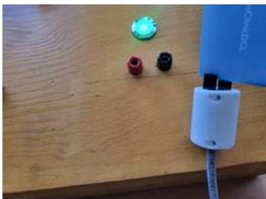
Rys. 20. Testowanie czujnika szczelinowego – po prawej przecięcie wiązki światła w szczelinie sensora ustawia stan wysoki na wyjściu sterownika, po lewej wiązka światła niezaburzona.
