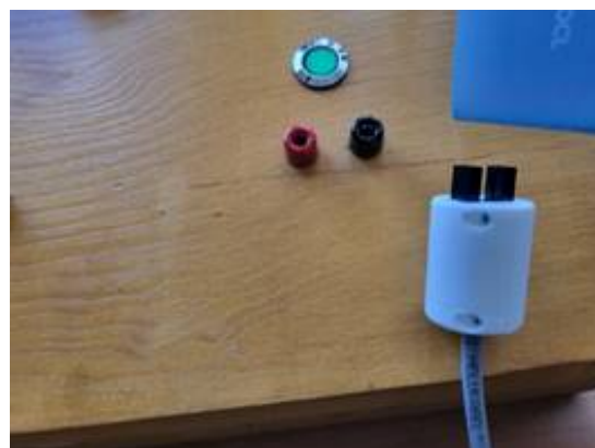
Rys. 20. Testowanie czujnika szczelinowego – po prawej przecięcie wiązki światła w szczelinie sensora ustawia stan wysoki na wyjściu sterownika, po lewej wiązka światła niezaburzona.
