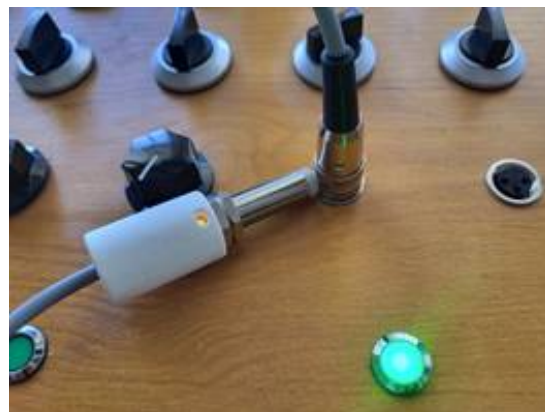
Rys. 19. Testowanie czujnika indukcyjnego – wykrycie metalowego obiektu włącza diodę sensora i wystawia stan wysoki na wyjściu Q3 (zielony sygnalizator).
