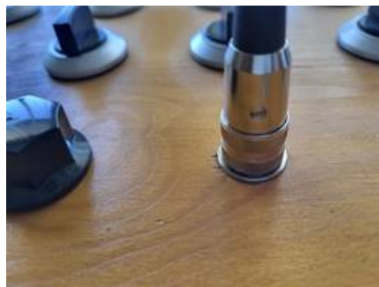
Rys. 17. Widok wtyku sensora – po lewej przed dokręceniem pierścienia zabezpieczającego, po prawej po dokręceniu pierścienia do gniazda.
