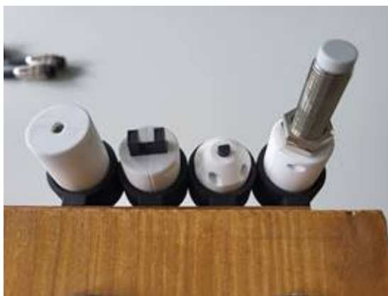
Rys. 15. Widok sensorów – po lewej z perspektywy użytkownika (od lewej: natężenia światła, szczelinowy, temperatury i indukcyjny), po prawej od tyłu obudowy.
