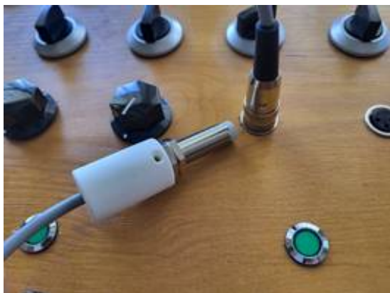
Rys. 19. Testowanie czujnika indukcyjnego – wykrycie metalowego obiektu włącza diodę sensora i wystawia stan wysoki na wyjściu Q3 (zielony sygnalizator).
