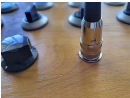
Rys. 17. Widok wtyku sensora – po lewej przed dokręceniem pierścienia zabezpieczającego, po prawej po dokręceniu pierścienia do gniazda.
