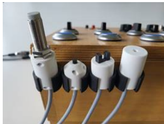
Rys. 15. Widok sensorów – po lewej z perspektywy użytkownika (od lewej: natężenia światła, szczelinowy, temperatury i indukcyjny), po prawej od tyłu obudowy.
