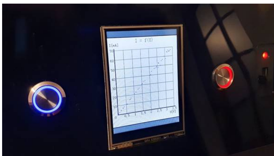
Rys. 7. Wyświetlane na wyświetlaczu wartości napięcia i natężenia w postaci punktów na wykresie, przycisk „reset” oraz przycisk „stop”.
