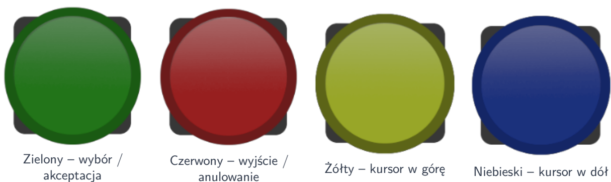
Rys. 2. Przyciski odpowiedzialne za poruszanie się po menu sterownika.
