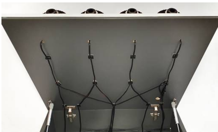
Rys. 3. Przymocowanie przewodów do pokrywy górnej.
